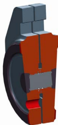
Защита средней части сверлением одного диска клина
